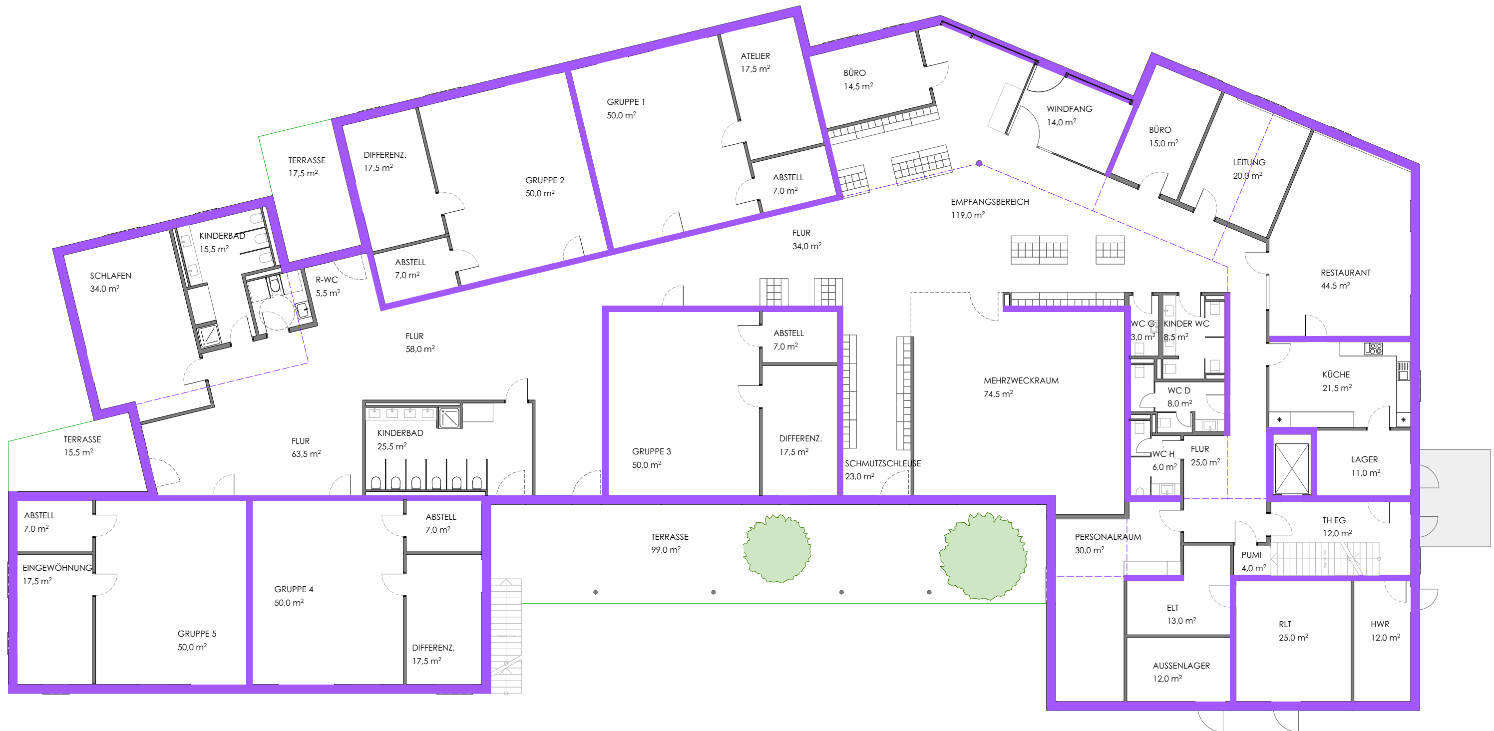
Grundriss Kita Vorschlag - EG tragende Wände
