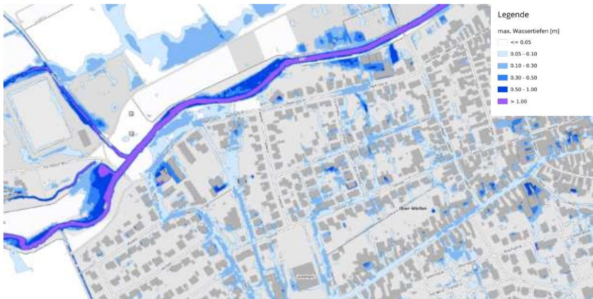
Abbildung 17: Kartenausschnitt der Ergebnisse der Starkregenerberechnung. Hier, max. auftretende Wassertiefen während der Simulation. Dabei werden Wassertiefen < 0.05 cm ausgeblendet.
