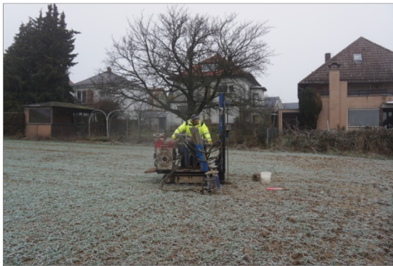
Abbildung 6: Durchführung der Rammsondierung DPH 2
