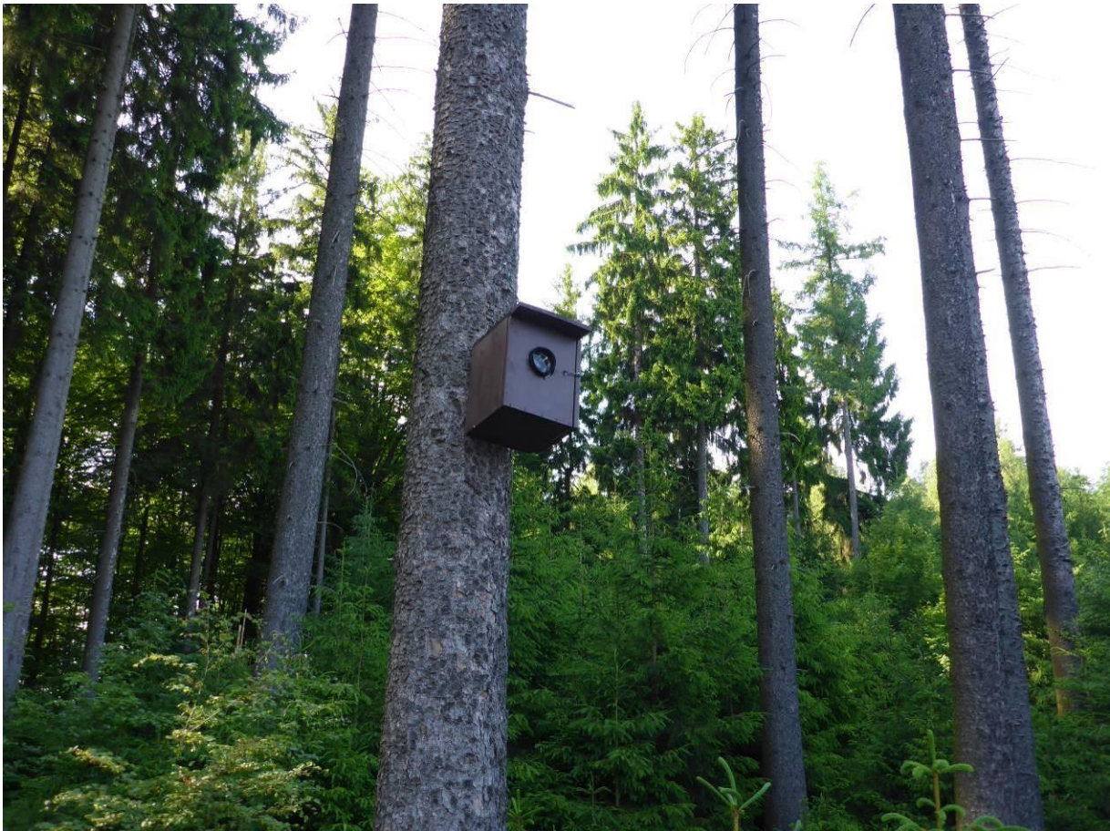
Abb. 11: Bioakustisches Dauererfassungsgerät in einem Kasten getarnt.
