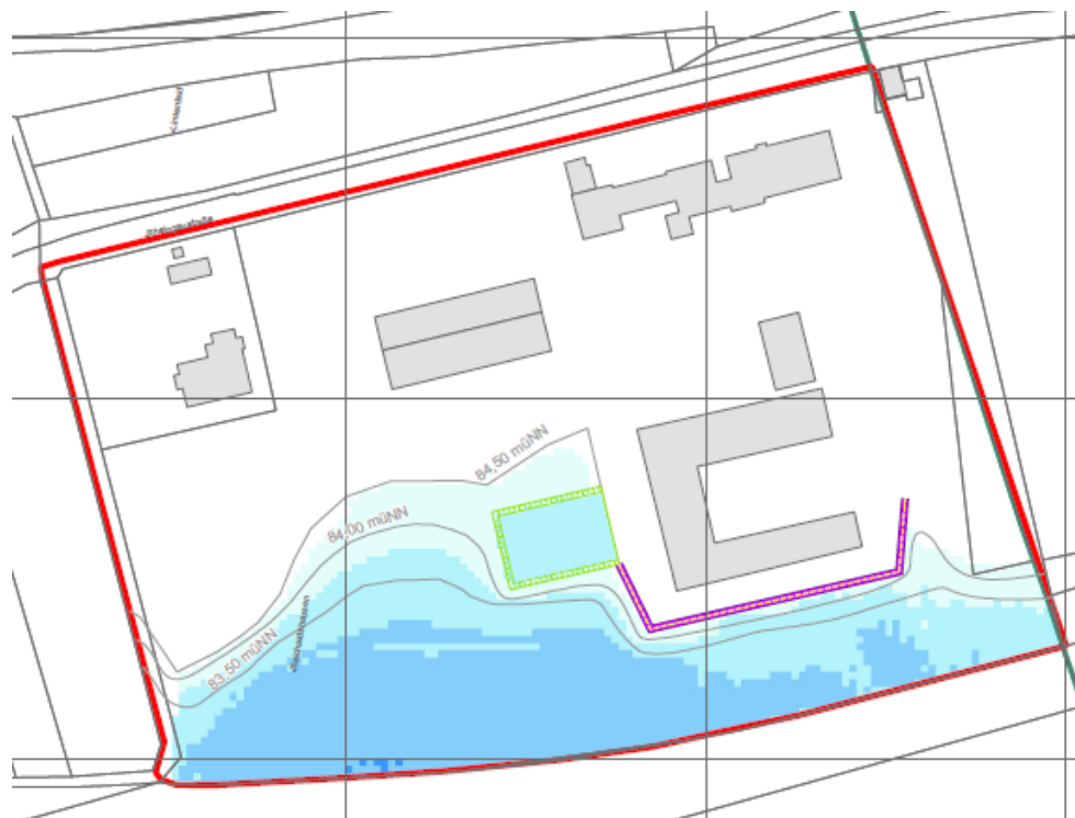
Abbildung 5: potentielle Überflutungssituation bei HQ100 im PLAN-Zustand
