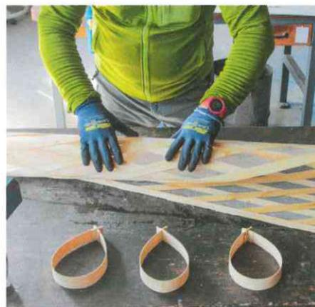
Abb. 4: In Serienfertigung wird die Hülle zusammengerollt und mit Haltebändern aus Holz in Form gehalten.
