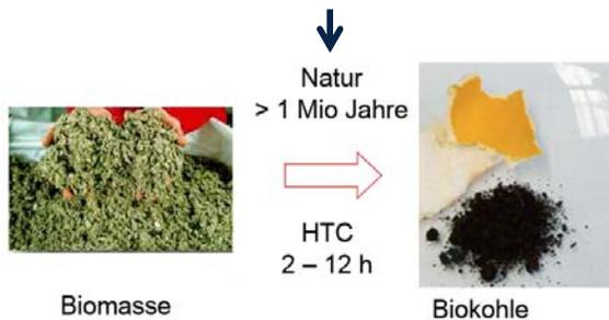
Als Ausgangsmaterialien können biogene Reststoffe und Abfallbiomassen, wie z. B. Klärschlamm, kommunale Abfälle, Destillationsrückstände etc. eingesetzt werden
