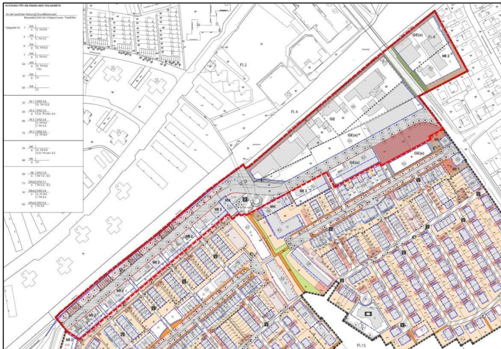
Abb.: Auszug aus der Planzeichnung des rechtskräftigen Bebauungsplans (6. Änderung) mit dem Geltungsbereich der 10. Änderung (rot umrandet)
