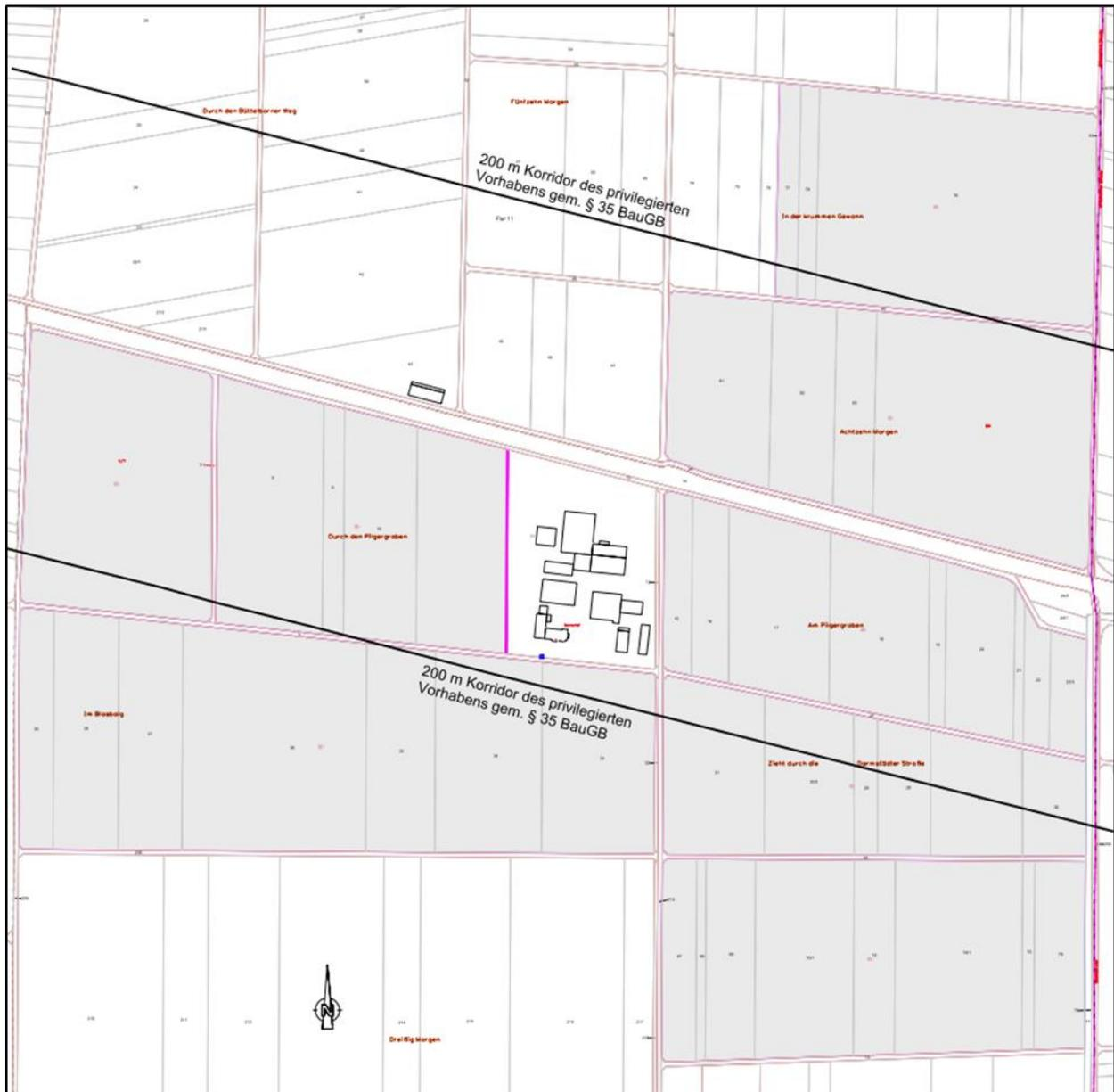
**Abbildung 8: Plangebiet mit Darstellung des „Privilegierungsbereiches“ gem. § 35 BauGB (200 m-Korridor beidseitig der Bahnstrecke (eigene Darstellung auf Grundlage des aktuellen Katasters)**
