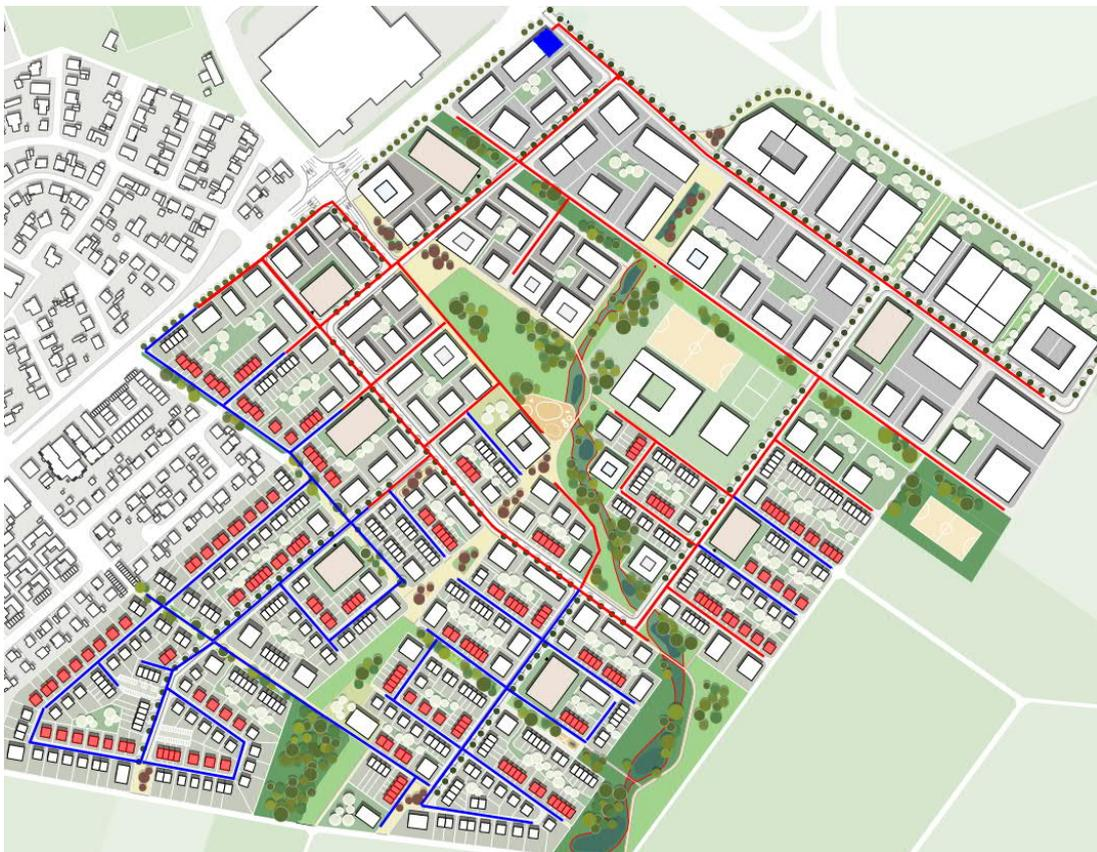
Abb. 23: möglicher Verlauf Nahwärmenetz (rote Leitungen: nur dichteres Teilgebiet, rote+blaue Leitungen: Gesamtgebiet)
