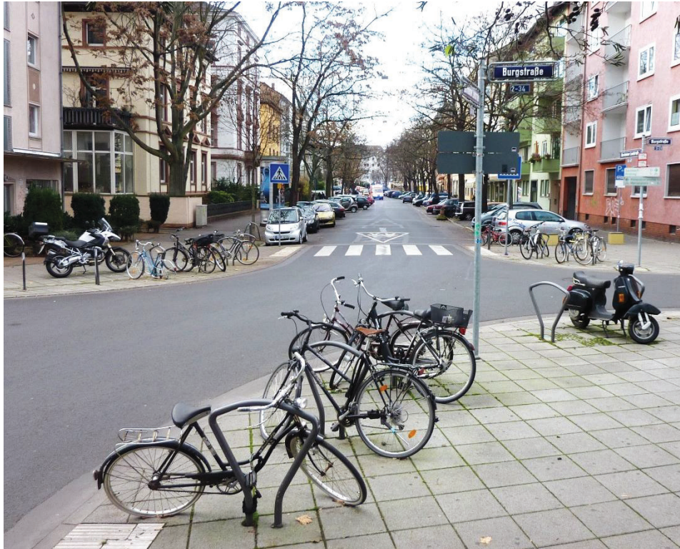
Abbildung 12: Fahrradbügel im Knotenpunktsbereich in Frankfurt
