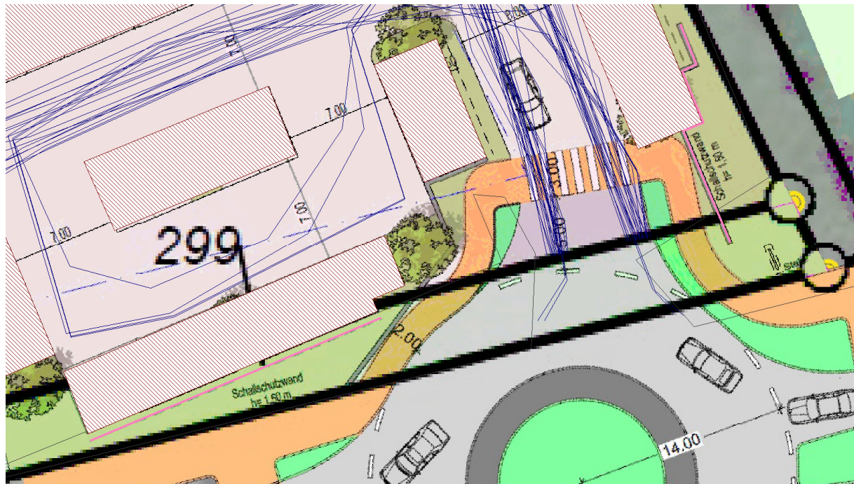
Bild 1: Darstellung der Schallschutzwände beidseitig der Zufahrt zum Betriebsgelände.
