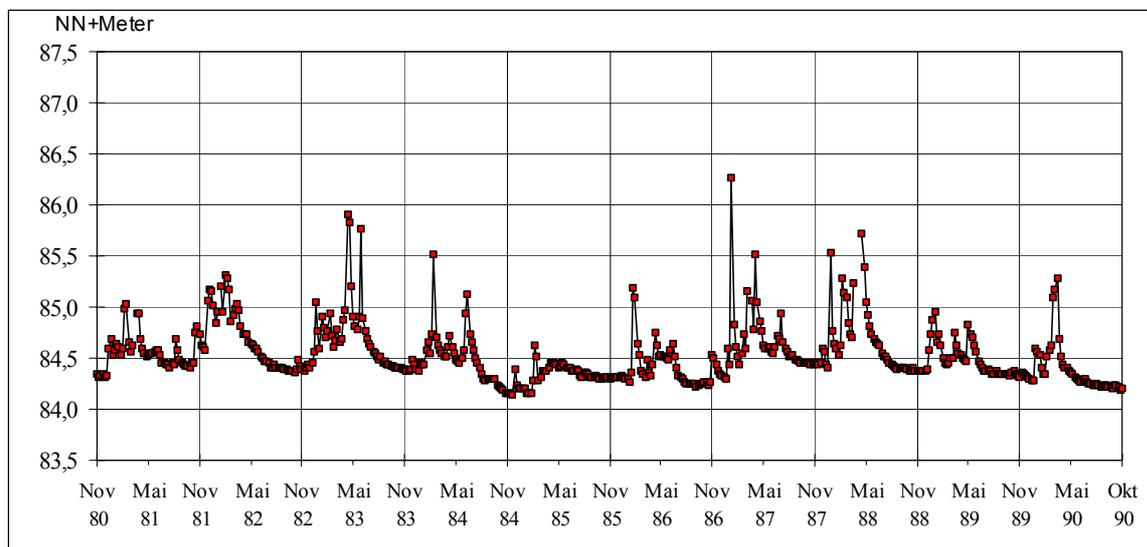
Abbildung 5 Grundwasserstandsganglinie Messstelle 507150 (1980 - 1990)
