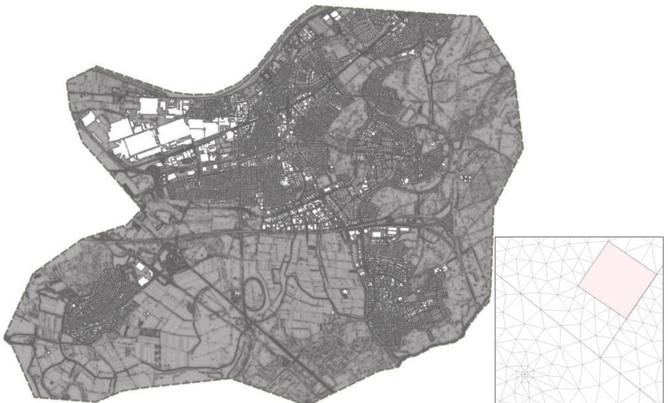
Abbildung 15: Gitternetzmodell innerhalb der Modellgrenze (Übersicht und Detail)
