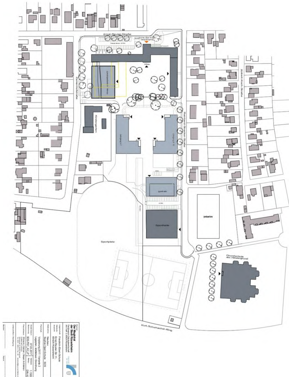
Abbildung 4: Vorplanung zur Umgestaltung des Schulgeländes der Friedrich-Ebert-Schule. Dunkelgrau: Gebäude Bestand, hellgrau: Gebäude Planung, gelb umrandet: Abriss Gebäude. Quelle: Stadt Rüsselsheim, Stadtplanungsamt.
