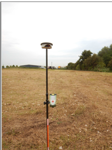
Foto: Leica-GPS zum Einmessen der Messabschnitte
