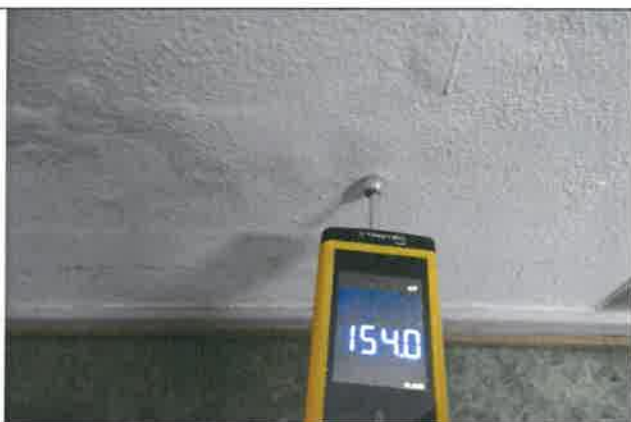
Foto 2: wie Foto 1, Ausblühungen auf der Wandfläche in Folge erhöhter Feuchte
