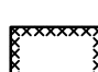
Umgrenzung der Flächen, bei deren Bebauung besondere bauliche Vorkehrungen gegen äußere Einwirkungen oder bei denen besondere bauliche Sicherungsmaßnahmen gegen Naturgewalten erforderlich sind (§ 9 Abs.5 Nr.1 und Abs.6 BauGB) - hier: Bestand Allablagern
