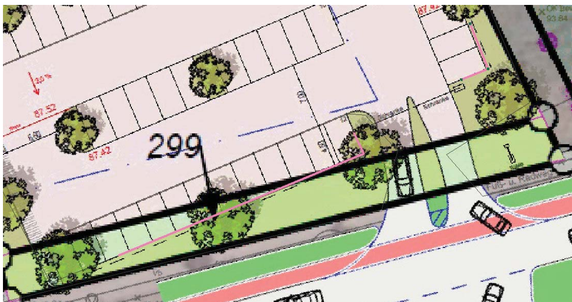
Bild 2: Ausschnitt aus dem digitalen Geländemodell, Verlauf der Schallschutzwand
