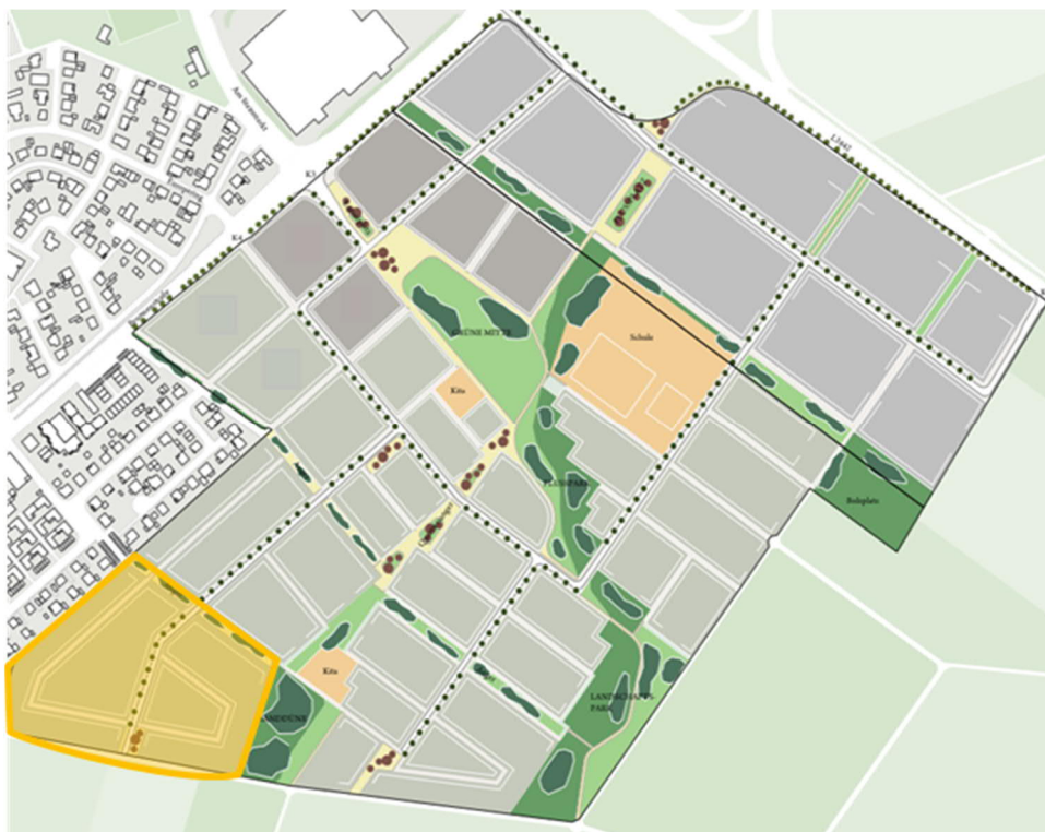
Abb. 24: Abgrenzung Teilgebiet für kalte Nahwärme mit Grundwasser
