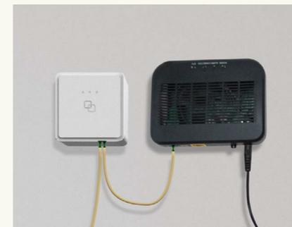
Die Platzierung erfolgt idealerweise in unmittelbarer Nähe des GF-TA (0,3–0,5 m), da dieser das Glasfaser-Signal an den NT übergibt. Voraussetzung ist eine 230-V-Stromanbindung im Umkreis von 1,2 m.
