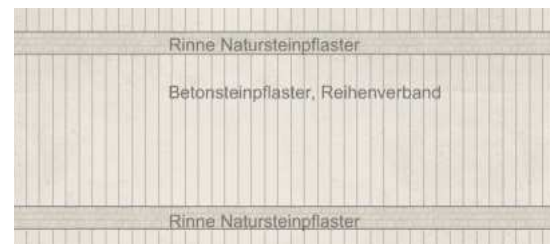
Oberflächen Betonsteinpflaster mit Rinnen Natursteinpflaster
