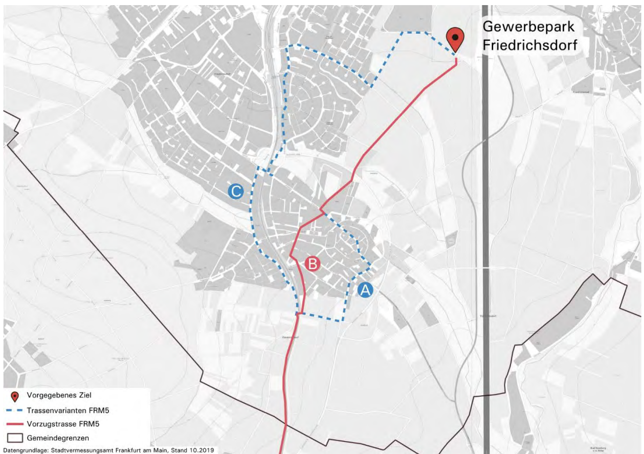
Abb. 29 Vorzugstrasse und Trassenvarianten im Bereich Friedrichsdorf
