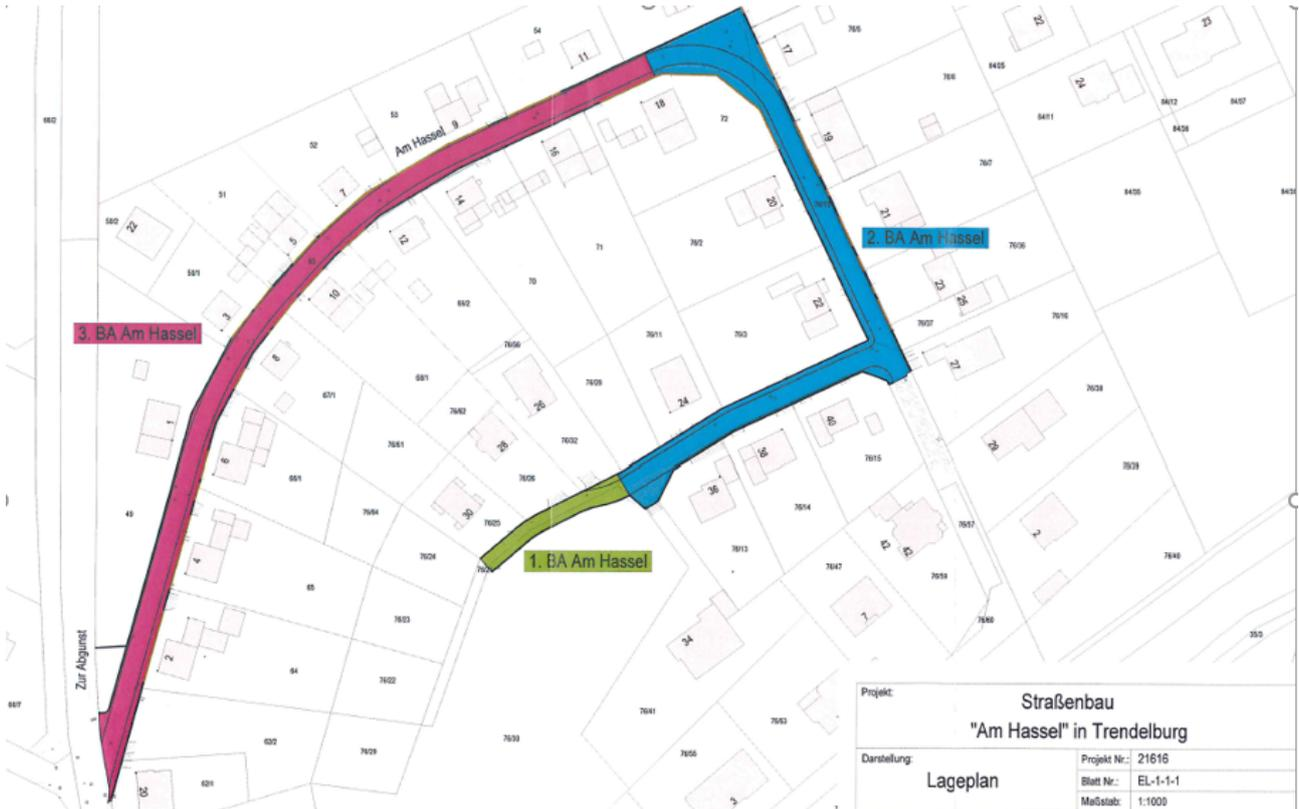
Nach § 12 der EBS der Stadt Trendelburg gilt eine Erschließungsanlage als endgültig hergestellt, wenn die Erschließungsanlage über Fahrbahn und Gehwege mit entsprechendem Unterbau, Entwässerungs- und Beleuchtungseinrichtungen verfügt. Beim Ausbau 2018/2019 wurde die entsprechende Fahrbahn mit Entwässerungseinrichtung und Beleuchtung hergestellt. Aufgrund der eingeschränkten Platzverhältnisse musste aber auf die Herstellung eines Gehweges verzichtet werden (siehe nachfolgendes Foto).
