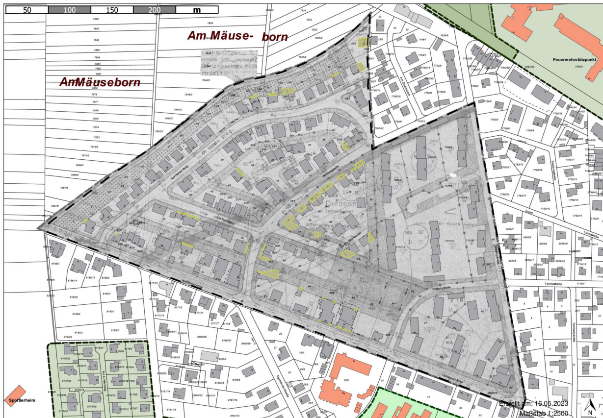
Abb 5: Baugrenzüberschreitungen im Bebauungsplangebiet „Altenwohn- und Pflegeheim“ (Quelle: Stadt Usingen)
