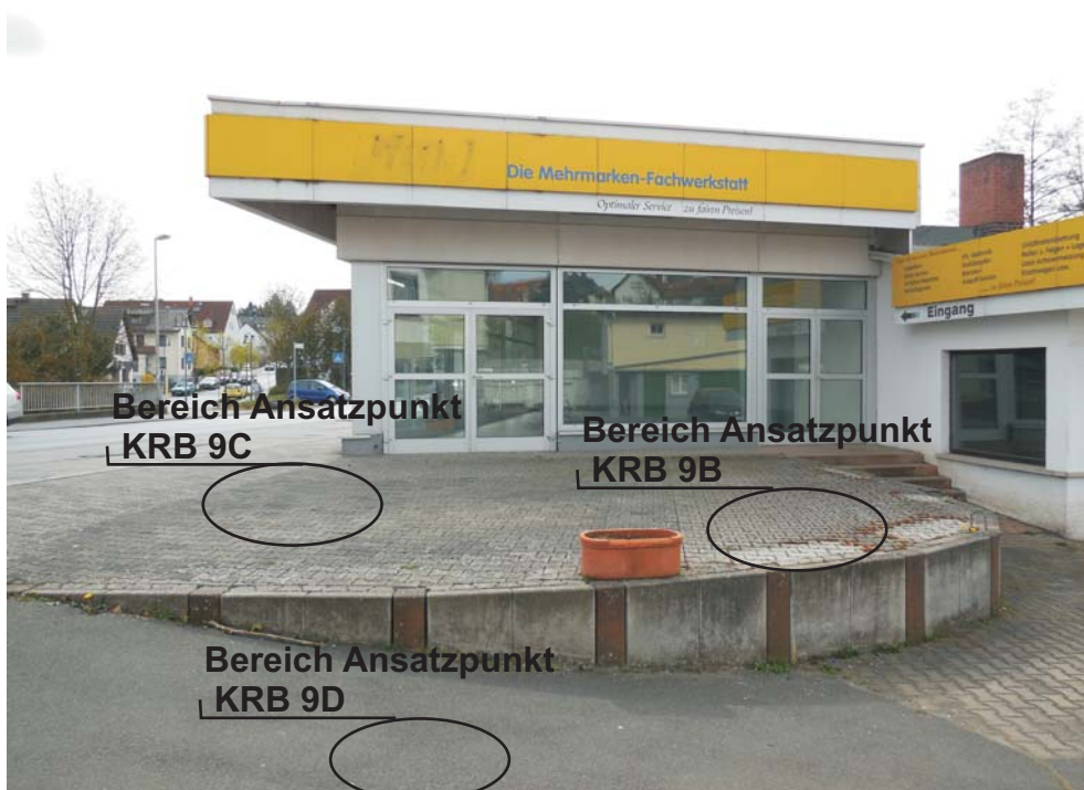
Bild 06: Blick auf den Bereich der ehem. Tankstelle. Augenscheinlich sind keine technischen Einrichtungen der Tankstelle (Domschächte, alte Befüllstutzen o.ä.) erkennbar. In der Ausstellungshalle ist ein viereckiger Deckel sichtbar, aufgrund des ungeklärten Medienverlaufs konnte dort nicht erkundet werden. Eine Handschachtung war in der Ausstellungshalle ebenfalls nicht möglich. (Blickrichtung: Nord, Aufnahmedatum: 07.04.14)
