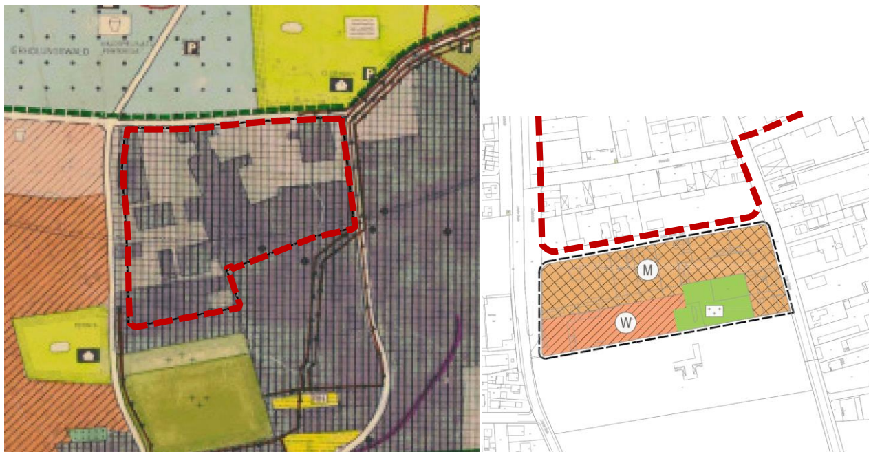
Abbildung 3: Ausschnitt aus dem Flächennutzungsplan der Stadt Viernheim mit Überlagerung des Geltungsbereiches (rote Abgrenzung) (links) und 17. Änderung des Flächennutzungsplanes mit Überlagerung des Geltungsbereiches des Bebauungsplans Nr. 233-7 (rote Abgrenzung) (rechts)
