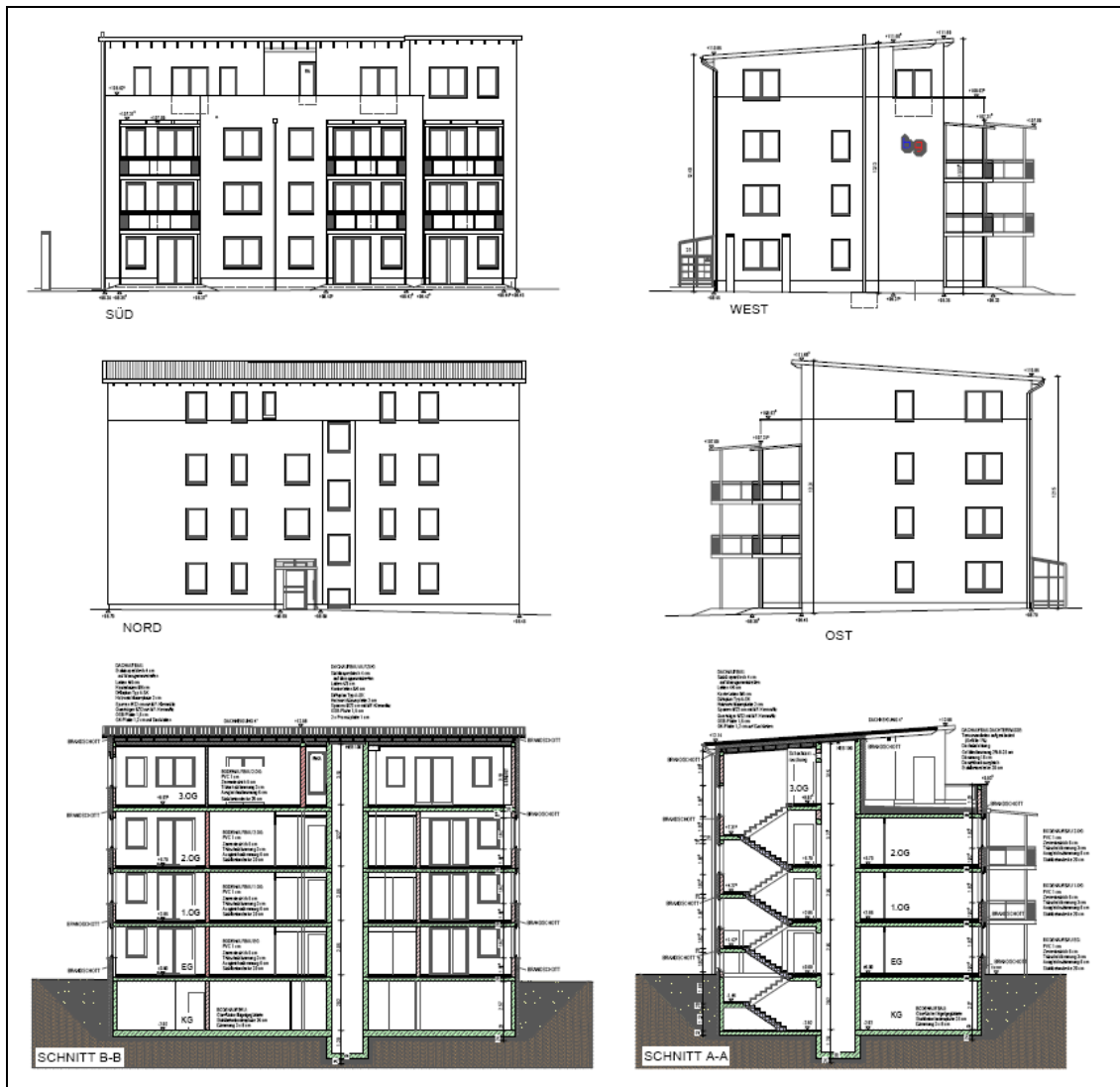
Ansichten und Schnitte des Vorhabens der Baugenossenschaft Viernheim e.G., Stand 05.04.2017, erstellt durch Baugenossenschaft Viernheim e.G.
