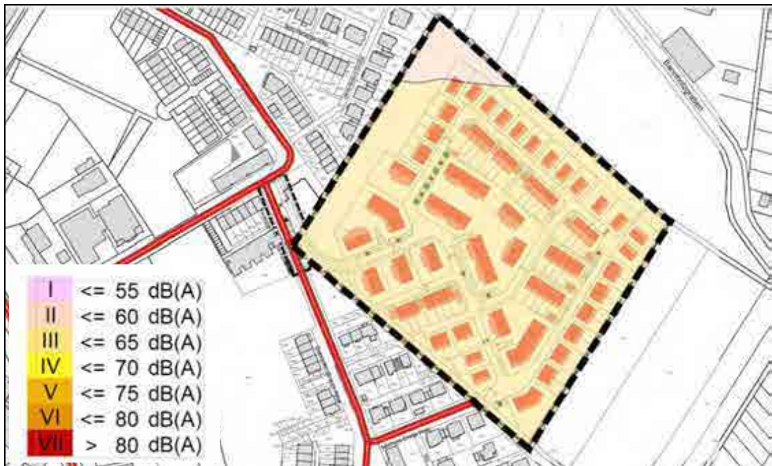
Maßgebliche Außenlärmpegel nach DIN 4109-1: 2016, Immissionshöhe über 6,3 m
