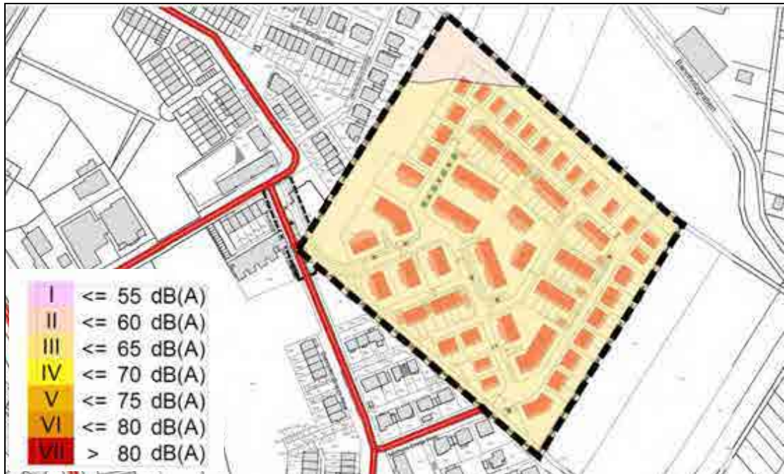
Maßgebliche Außenlärmpegel nach DIN 4109-1: 2016, Immissionshöhe über 6,3 m
