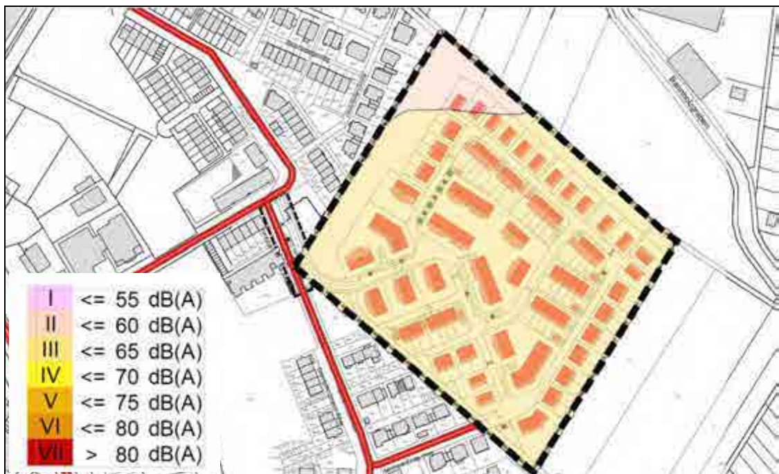
Maßgebliche Außenlärmpegel nach DIN 4109-1: 2016, Immissionshöhe: 3,5 bis 6,3 m
