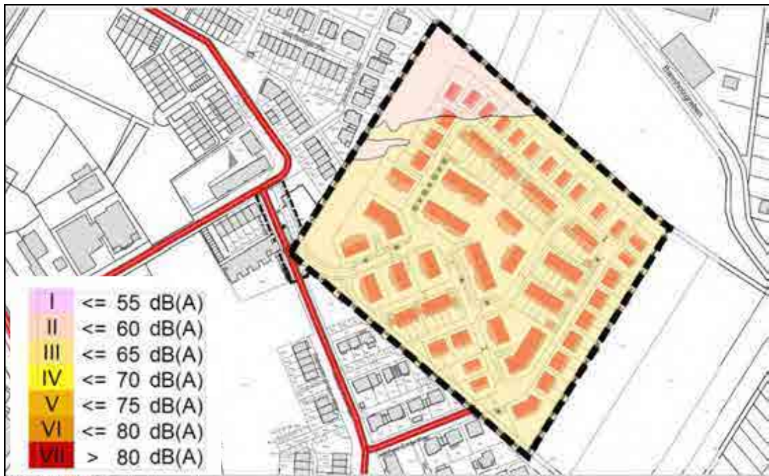
Maßgebliche Außenlärmpegel nach DIN 4109-1: 2016, Immissionshöhe bis 3,5 m
