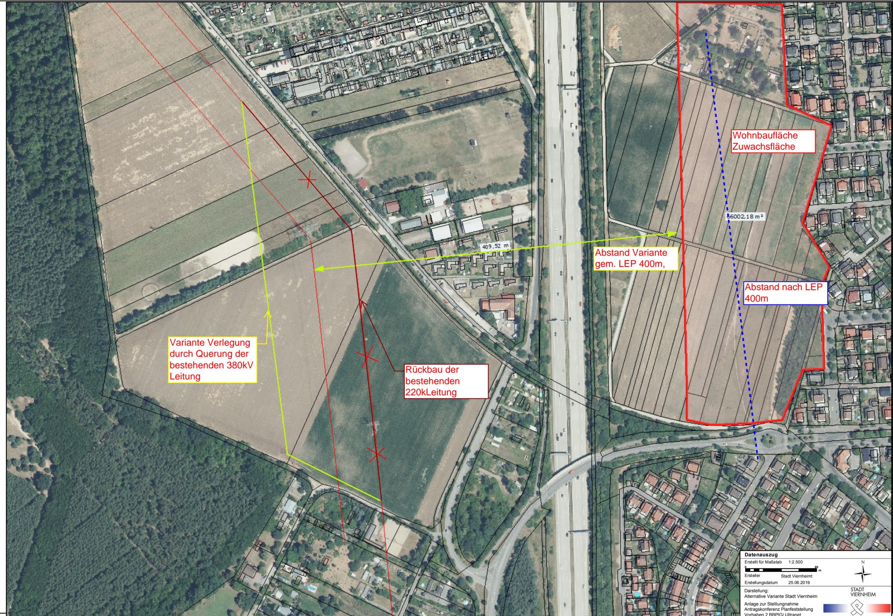
Variante Verlegung durch Querung der bestehenden 380kV Leitung
