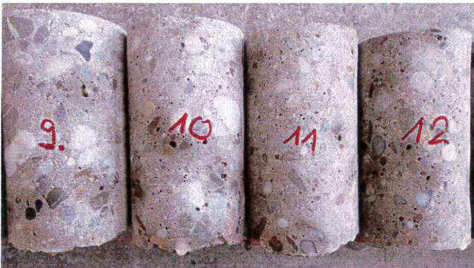
Stützen 10-12 Gleichmäßiges u. dichtes Gefüge
