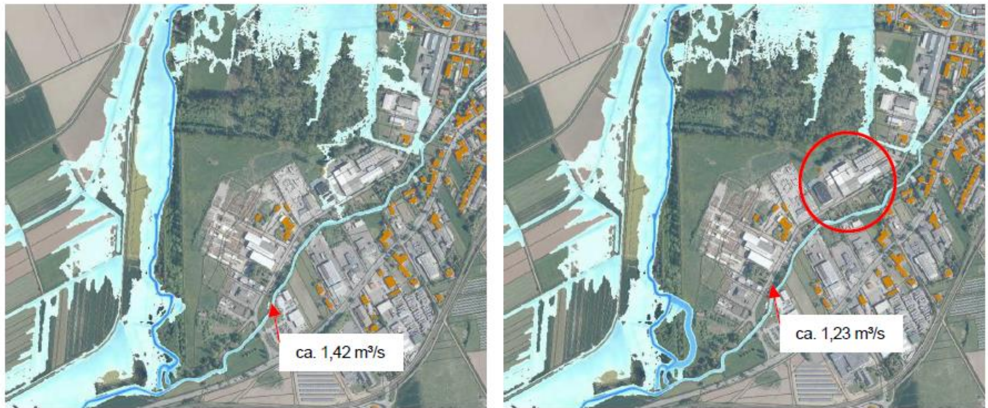
Abbildung 47: HQ 1 – Auswirkung der Variante c auf die Wassertiefen und das Überschwemmungsgebiet
