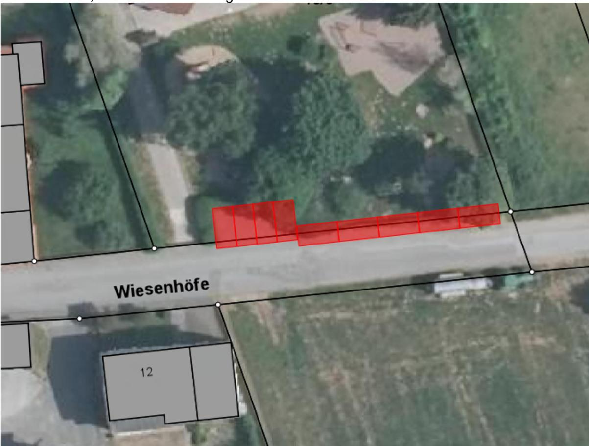
Im Beispielbild besteht eine Flächenverfügbarkeit unter optimaler Platzausnutzung für 9 Fahrzeuge. Bepflanzungen sollten, wenn möglich, aus Schattenwurfgründen nicht entfernt werden; der Zaun wäre dann zu versetzen.
