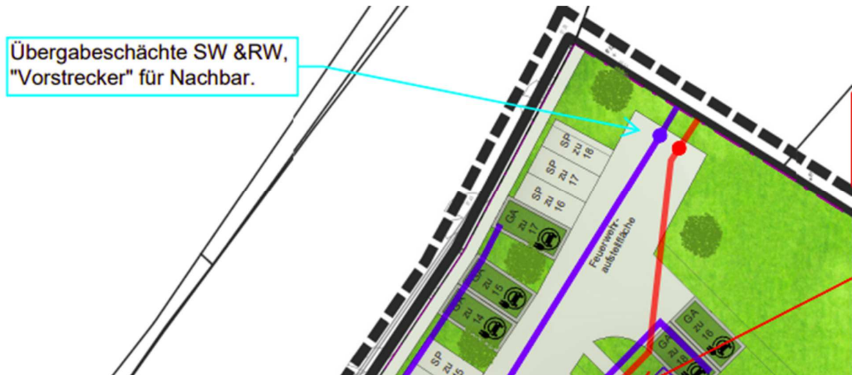
Abb.7 Prinzip der Entwässerung für das Nachbargrundstück
