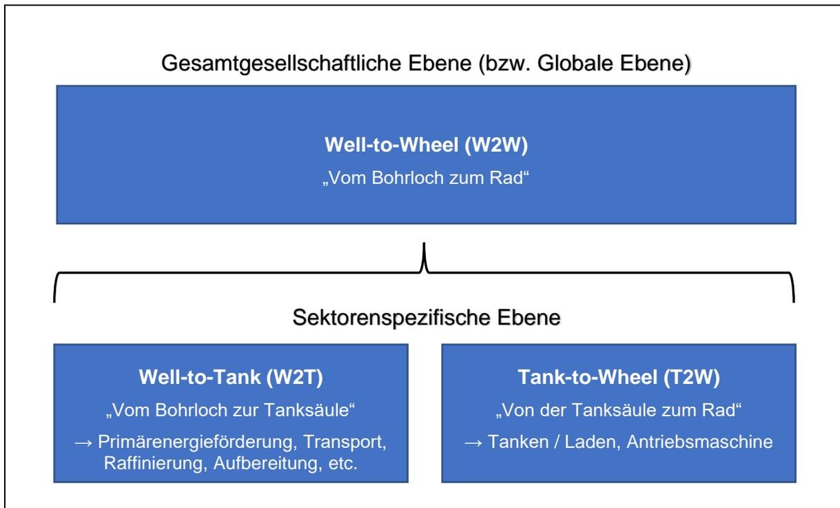
Abbildung 3-7: Zusammenhang Well-to-Tank-, Tank-to-Wheel-, Well-to-Wheel-Ansatz
