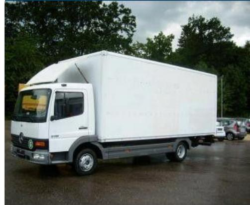
Zur Fahrzeugklasse N2 zählen z.B. Kastenfahrzeuge oder Kipper auf LKW-Rahmen („7,5-Tonner“)
