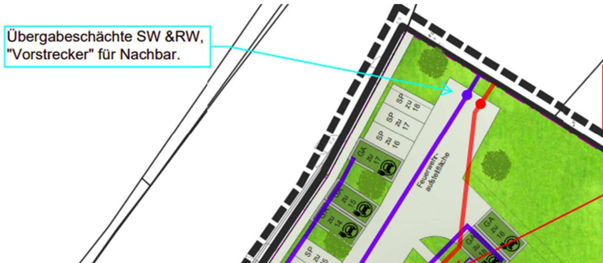
**Abb.7 Prinzip der Entwässerung für das Nachbargrundstück**
